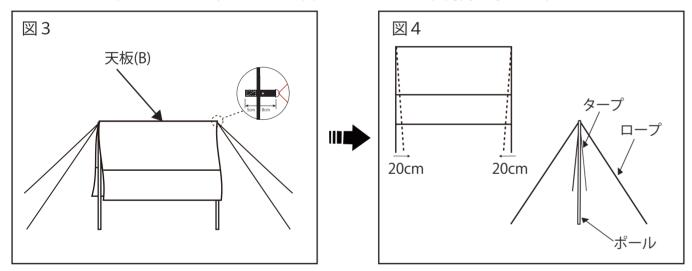
**3** 同様に残りのグロメットにロープを通し、自在金具で長さを調整しながらペグで地面に固定します。 降雨時は、雨水の通り道を作ってください。
